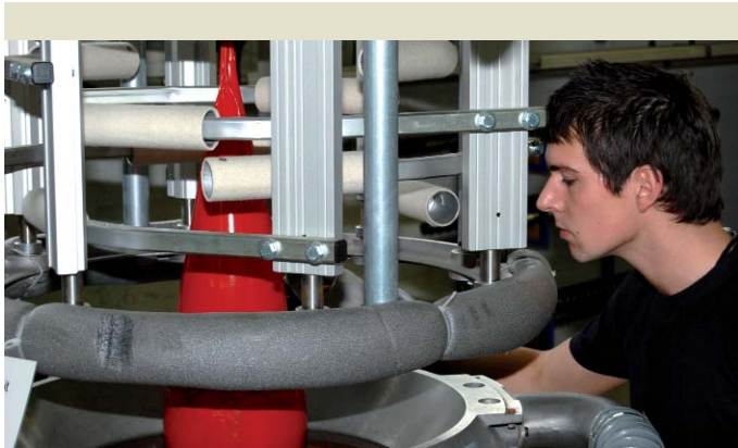
Kritischer Blick auf die rote Folie, die in der Blasfolienanlage auf dem Weg zur Tüte ist.
