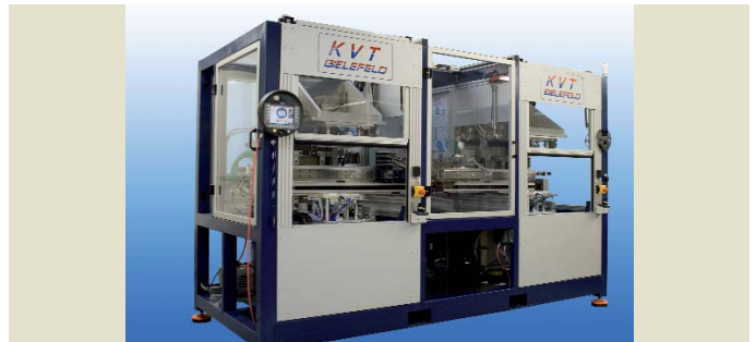
Berührungsloses Verschweißen von Hightech Thermoplasten: Die innovative Tandem-Schweißmaschine wurde von KVT entwickelt.
